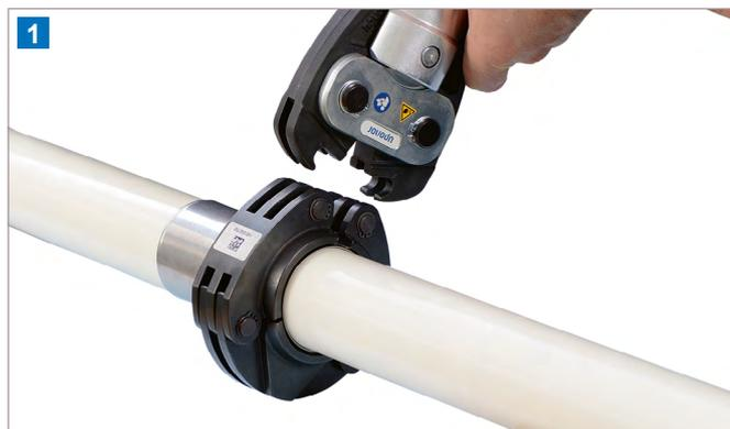
Insérer le tube, préalablement ébavuré, dans le raccord en buté. Utiliser l'extension de mâchoire appropriée (diamètre et couleur associés) autour de la bague inox, contre la bague de couleur.
