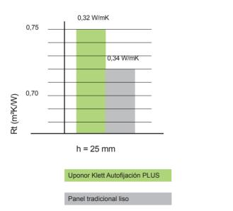
Comparativa (Rt) entre paneles fabricados en EPS modificado Vs EPS de igual espesor.
