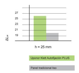
Comparativa de aislamiento acústico entre paneles fabricados en EPS modificado Vs EPS de igual espesor.
