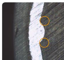
Tube avec soudure bord à bord
