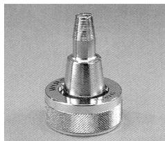
Figure 1 - Pince d'expansion Figure 2 - Tête d'expansion
