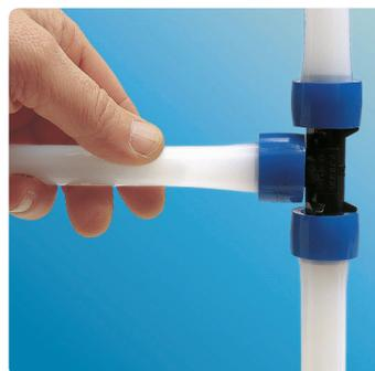
**Montage** : insérer le tube et le maintenir brièvement contre la butée du raccord, jusqu'à ce que le tube se soit contracté sur le raccord.
