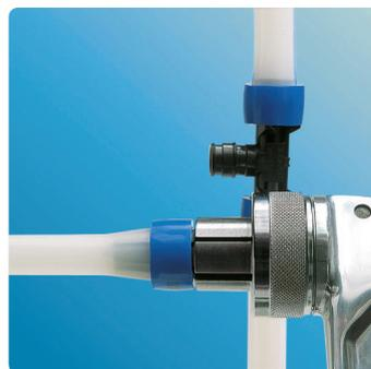
**Expandre** : insérer la tête d'expansion et procéder à l'expansion. Répéter l'opération jusqu'à la butée.
